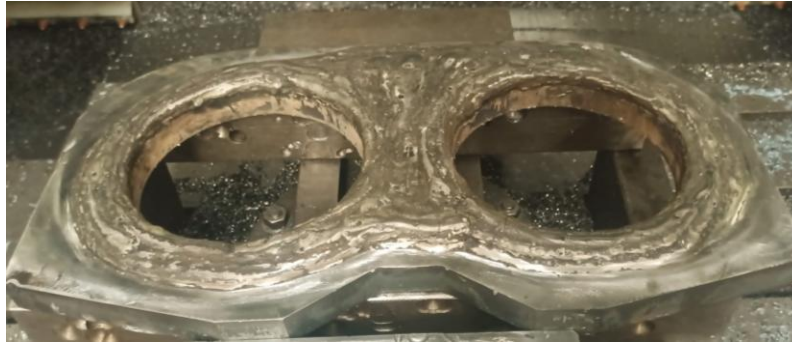
Şekil 11. Sert dolgu kaplama uygulanmış prototip ürünün CNC dik işleme tezgâhındaki görüntüsü.
